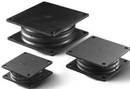
El soporte antivibratorio SH se compone de un elemento antivibratorio circular, con dos bases metálicas intercaladas internamente, y con dos bases cuadradas con cuatro orificios para su instalación. El soporte antivibratorio AMC-MECANOCAUCHO® tipo SH, ofrece una alta capacidad de carga estática y de sobrecargas puntuales a compresión con una mínima deflexión, manteniendo una baja rigidez radial.
