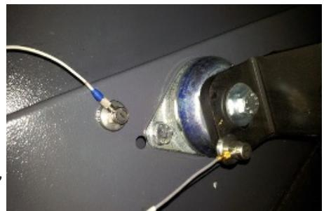
Es un soporte apto para el aislamiento de máquinas rotativas móviles que se encuentren expuestos a choques axiales y radiales goteos de aceite, diesel o exposición a la intemperie.
