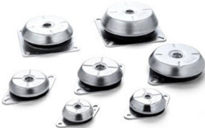
Los soportes antivibratorios motor BSB AMC-Mecanocaucho® son antivibratorios en donde el elastómero trabaja a cizalla- compresión con una óptima relación de rigidez y estabilidad horizontal. Este soporte motor es realmente interesante cuando la estabilidad sea lo prioritario en una suspensión antivibratoria. En aplicaciones donde el grado de aislamiento sea prioritario, deberemos de elegir la gama de antivibratorios AMC-Mecanocaucho® soporte antivibratorio de campana BRB.
